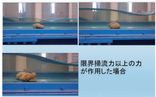
実際に石の壊れ方ですけども、単独に石を置いた時に水の量を少し増やした時、このように、おむすびが転がるようになります。それから、今度は45度に傾けた場合はこちらです。初めは頑張っているのですけれども、バランス少しでも崩すと、どうなるか。このように、連鎖反应的に崩れます。では、20度、30度の傾きで石を1列組んだ場合。少し移動するのですが、この後また止まります。つまり、崩れにくいのですね、たった1個でも。このように、石の組み合わせをうまく適切に評価して、置き方を確立すれば、ものすごく安定した形で石が組めます。さらには、石を組んでいくと、こういう石同士の間空間に魚が利用できる空間ができるのです。
